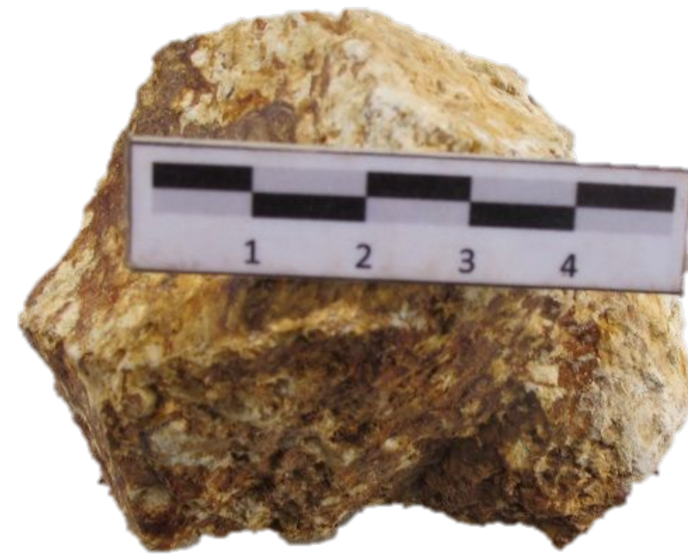
Cuarzoandesita porfirítica con alteración fílica (arcillas)
