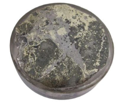
Sección pulida (briqueta) Ø (30-40 mm)
